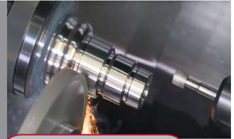
Außenschleifen mit 25.000 [U/min] 7 [kW]
