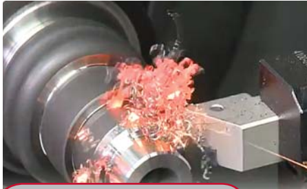
Drehen mit Spindel W25 7.000 [min -1 ] 6 [kW]
