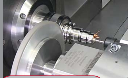
Innenschleifen mit 60.000 [U/min] 6 [kW]
