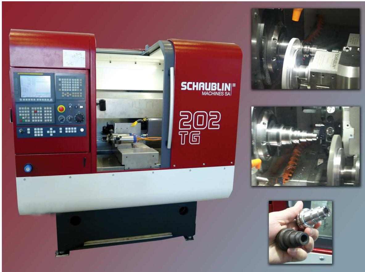
***Schleifen ist mit der 202TG als Einzelprozess beziehungsweise im Verfahrensmix etwa mit einer Drehapplikation möglich.***
