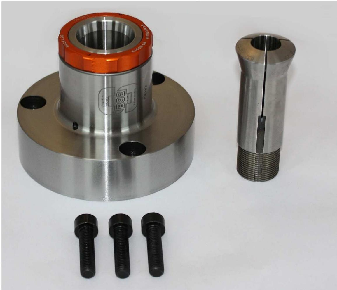
***SCS-Spannzangenfutter B32 bzw. B45 mit Ratschenfunktion sind passend für Spindeln A2-4, A2-5 und A2-6 und garantieren hervorragende Rundlaufgenauigkeiten, höchste Präzision und Wirtschaftlichkeit. Die Schaublin-farbtypische orangene Abdeckmutter schützt das Außengewinde vor Spänen und Schlägen.***
