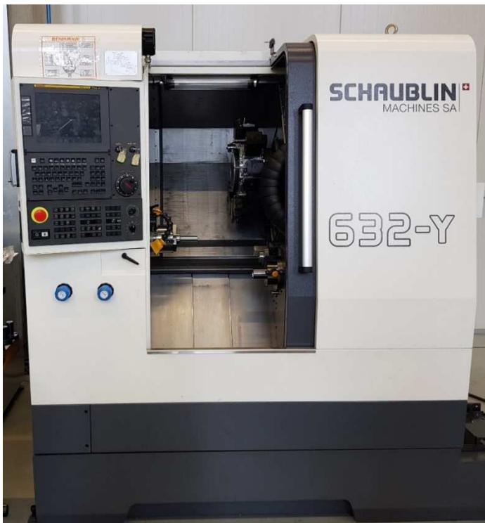
***Mit den 632-Y-Modellen schreibt Schaublin die Erfolgsgeschichte der legendären 110er-Baureihe weiter: als Hochpräzisions-Drehmaschine mit Antrieb der Achsen X, Y und Z + (E, Xt).***
