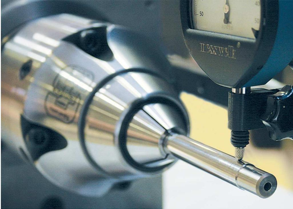
***Da mit der „302“ auch geschliffen werden kann, ist der Anwender in der Lage, dank des selbsthemmenden SRS-Systems die Spannzangen noch genauer einzustellen.***
