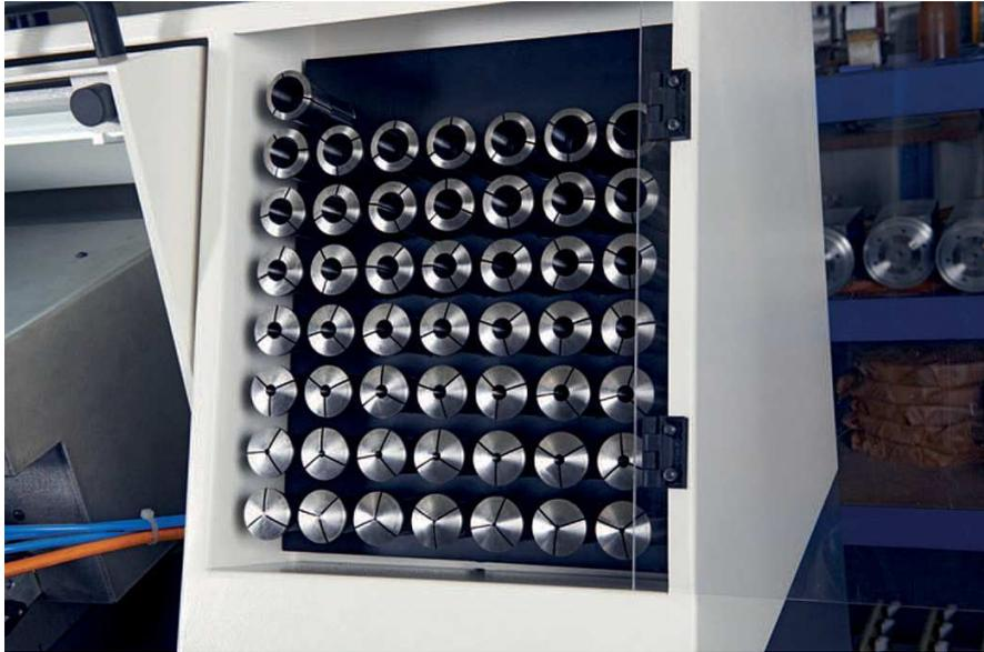
***Alle SCHAUBLIN Spannzangen der Ausführung W20 oder W25 können in dieser Maschine verwendet werden.***
