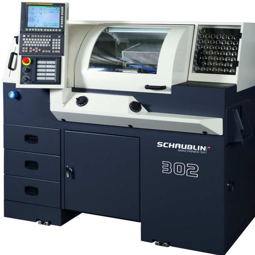
***Drehen, Schleifen, Bohren, Fräsen und mehr – mit 12 Werkzeugplätzen im Sauter Revolverkopf sowie optionalen Schleif- und Fräsapparaten hat der Schweizer Maschinenbauer SCHAUBLIN mit der „302 eine neue Universal-Präzisions- und Produktions-Drehmaschine im Programm.***
