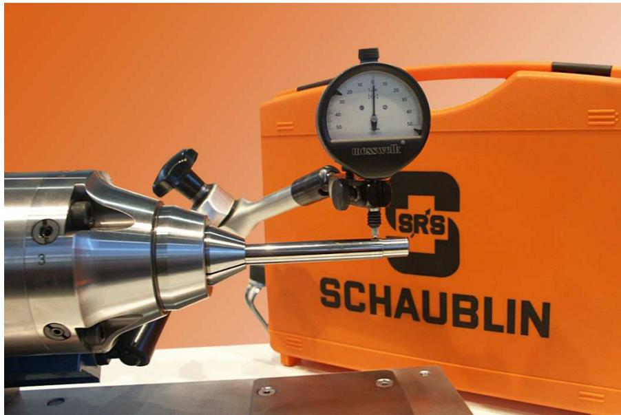
***Durch das Rundlaufregel-System SRS lassen sich Spannzangen auf nahezu kaum messbare Rundlauf- und Taumelfehler wiederholbar einstellen.***
