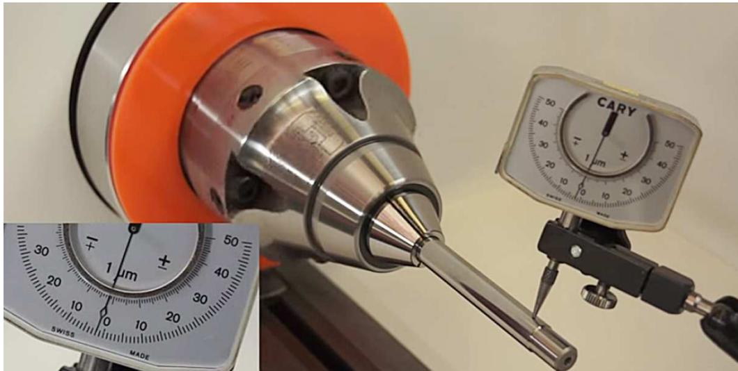
***Mit dem Runout Adjustment System (SRS) ist der Zerspaner in der Lage, die Konizität von Spannzangen auf zwei Ebenen ohne große Fachkenntnisse auf den Mikrometer genau einzustellen. Rundlauf- und Taumelfehler über 2 µm kommen dadurch auch in der Großserie nahezu nicht mehr vor.***
