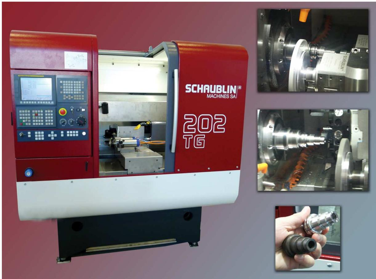
***Mit dem CNC Schleif- und Drehzentrum TG 202 kann der Anwender in einer Aufspannung hartdrehen, fräsen und schleifen. Damit ist es SCHAUBLIN gelungen, die konkurrierenden Verfahren Drehen und Schleifen zur Komplettbearbeitung von hoch anspruchsvollen Bauteilen unter einer Maschinenhaube zu vereinen.***
