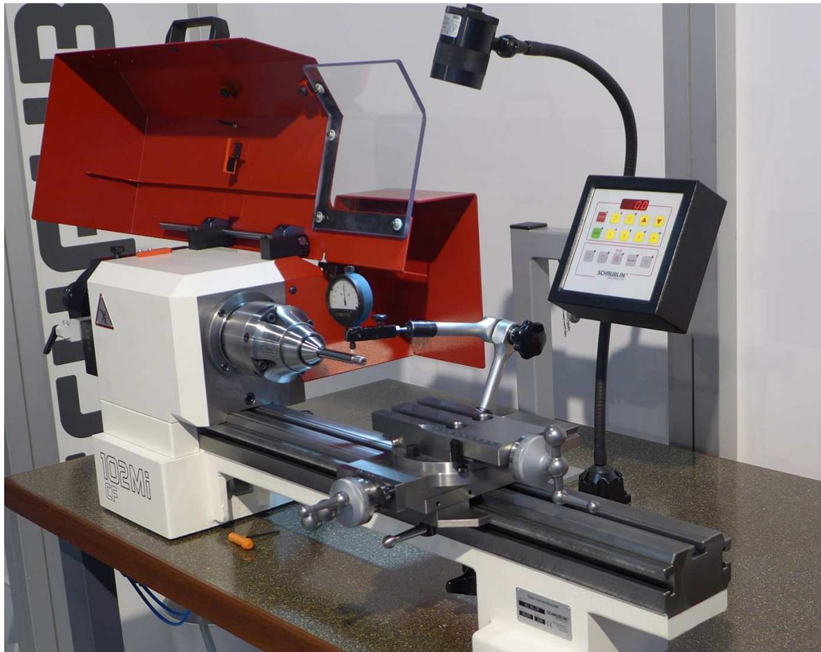
***Mit dem SRS System ist es möglich, Rundläufe im Mikrometerbereich ohne nennenswerten Aufwand in kürzester Zeit wiederholbar einzustellen.***
